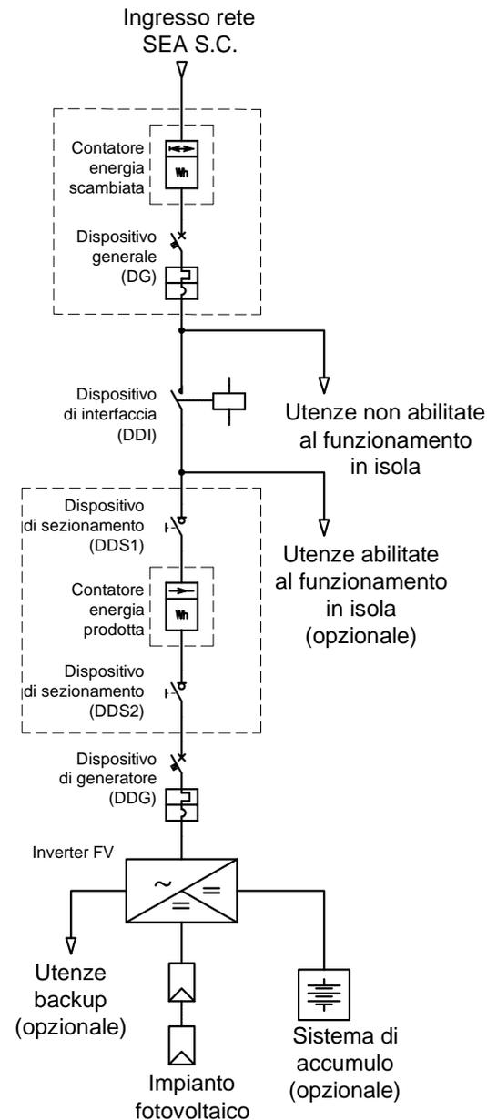
**COLLEGAMENTO ALLA RETE IMPIANTO FOTVOLTAICO CON DDI INTERNO ALL'INVERTER**
